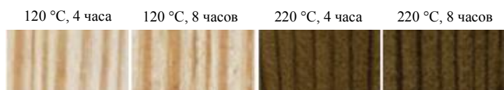
Рис. 1. Образцы древесины сосны обыкновенной при воздействии температуры 120 °С и 220 °С в течение 4 и 8 часов
