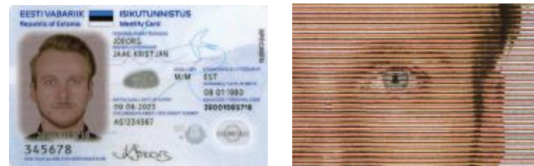
Рис. 2. ID-карта Эстонии с фрагментом увеличенного фотоизображения, персонализированная при помощи технологии Lasink
