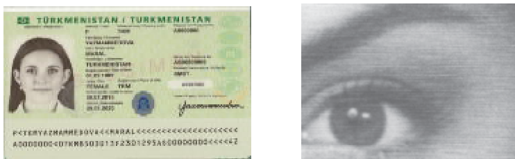
Рис. 1. Страница с установочными данными паспорта Туркменистана с фрагментом увеличенного фотоизображения, персонализированного при помощи лазерного гравирования
